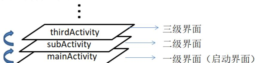
首先我们的应用起来后会先进入 **mainActivity** 对应的界面，即启动界面，之后通过 **openActivity** 方法打开了 **subActivity** 对应的界面，接着再进入 **thirdActivity** 对应的界面，就形成了上图所看到的层级效果了；后打开的界面在层级上层，它们间形成了栈的这样一种关系。
